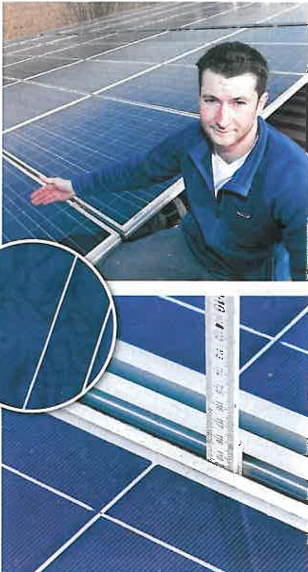
Alois Rettenberger vor seinen Modulen, die fast vollständig von Schneckenspuren gezeichnet sind. Die Rahmen um die Module lassen sich mit einem Zollstock vom Laminat wegziehen
